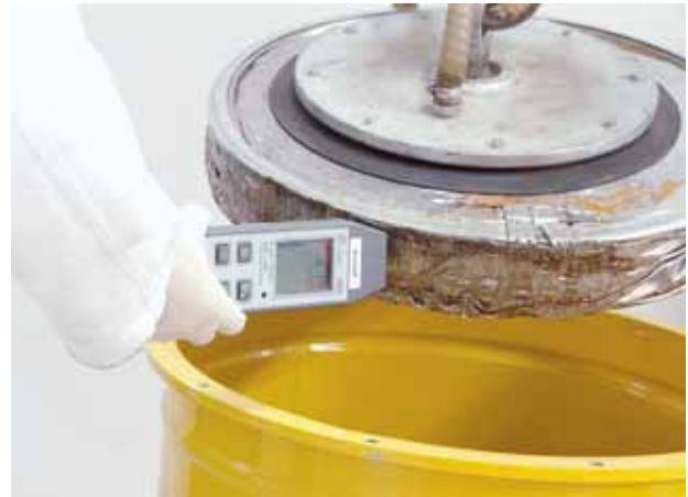
Vermessung und Verpackung eines schwach radioaktiven Abfallpresslings
