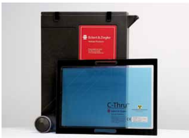
Flächenquelle für die Kalibrierung von diagnostischen Kameras in der Nuklearmedizin
