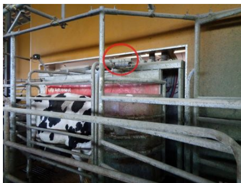
搾乳ロボットに設置した簡易メタンガスモニタリングシステム（赤丸の箇所）と計測データ収集の様子
