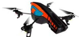
Pour un vol en **extérieur**, la carène profilée, disponible en 3 coloris (orange/jaune ; orange/vert ; orange/bleu), réduit la prise au vent et préserve la maniabilité et la stabilité de l'**AR.Drone 2.0**.
