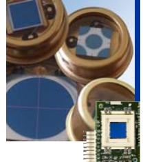
Die Produktionstätigkeit behält ihren Schwerpunkt bei kundenspezifischen Produkten mit einem teilweise sehr hohen Entwicklungsanteil. Schwerpunkt sind weiterhin kundenspezifische Hybridschaltungen, Packaging- und Sensorlösungen sowie Avalanche-Fotodioden.
