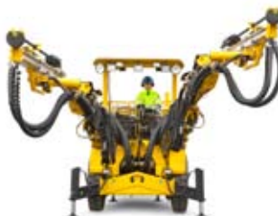
Tvåarmad borrar för tunneldrivning
