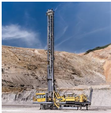
Epiroc Pit Viper 270 XC-serien med avancerat styrsystem med många automationsfunktioner.
