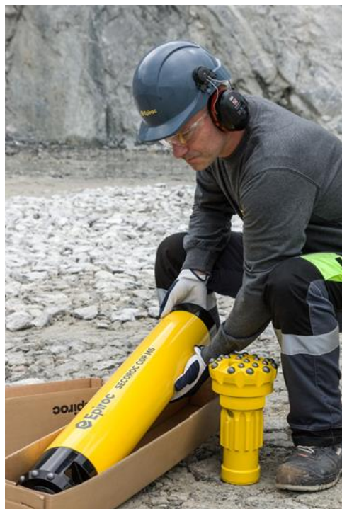
Den nya M-serien sänkborrhämmare är kortare, lättare och snabbare jämfört med sina föregångare.
