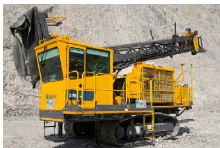
DM30 II SP med kapacitet för enrörsborrning minskar den totala produktionskostnaden per ton.
