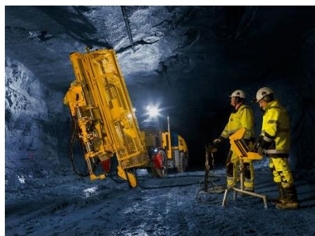
Epiroc har tagit prospekteringsbörning under jord ett steg framåt med introduktionen av Diamec Smart 6M, där M står för mobil.
