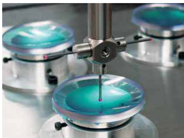
Inspektion av ytstrukturen av kontaklinser.
