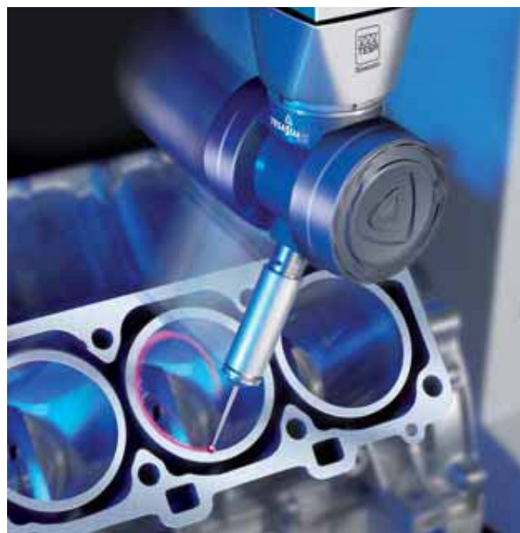
TESA Star Linear wrist, ett femaxligt sensorsystem, utvecklades under 2007. Mätssystemet är idealiskt för mätning av komplexa strukturer såsom kugghjul, blad och turbiner.
