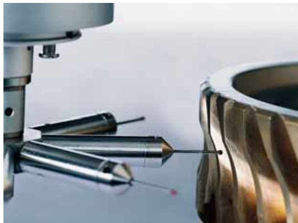
Extrem noggrannhet i alla storlekar och dimensioner: Koordinatmätmaskiner (CMM) ger maximal precision.
