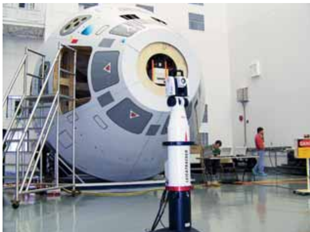
Himlen har inga gränser – en Laser Tracker från Leica Geosystems genomför kontrollmätningar vid NASA:s Goddard Space Flight Center.
