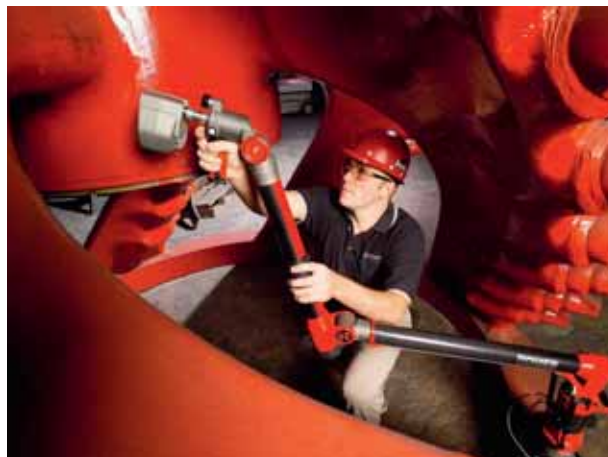
Portabla mätarmar ger full flexibilitet och rörlighet. Detta mätinstrument från Romer förs till det objekt som ska mätas, inte tvärtom.
