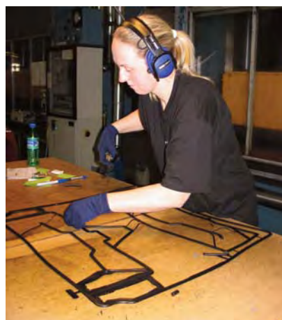
Jennie Andersson trimmar den formpressade AQUA-packningen. Foto: Gislaved Gummi AB.
