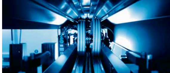
Fotot visar den X-vagn som bär på Precision-systemets slutlin, vilken glider på ett friktionsfritt luftlager.
