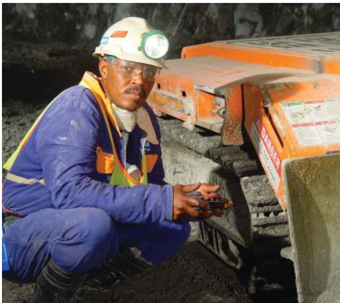
En av Sandvik Mining and Construction's serviceoperatörer i Sydafrika intill en mycket låg lastare, byggd speciellt för platinagruvors trånga orter.
