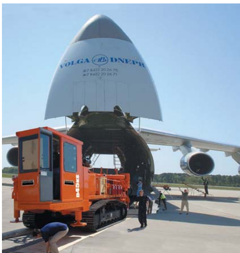
Lastning av en Sandvik D45KS, en rigg för ovanjordsbörning, på ett ryskt fraktflygplan av typen Antonov för transport till guldgruvan Kumtor i Kirgizistan.
