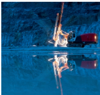
DTH-riggen DI550 i arbete.
