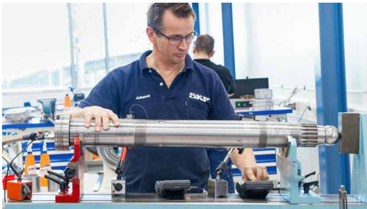
Juhani Knuuti, Spindeltekniker SKF Solution Factory i Göteborg. Efter demontering av spindeln kontrolleras alla detaljer, här kontrolleras axel för att avgöra om någon åtgärd krävs.
