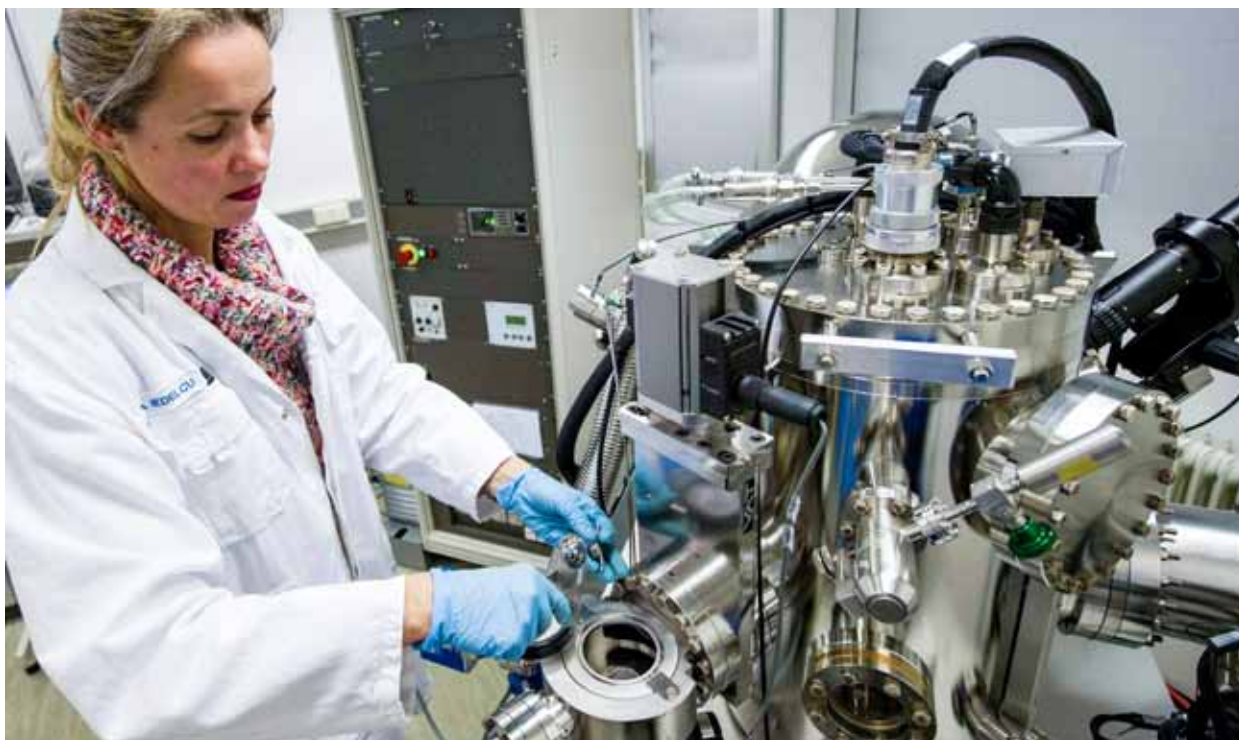
Ileana Nedelcu, forskare, Tribology and Lubrication Department, analyserar de kemiska egenskaperna på ett lagers löpbana med hjälp av XPS (X-ray Photoelectron Spectroscopy). Analysen görs för att ta reda på hur tillsatser i smörjmedel påverkar slitage och ytans livslängd.
