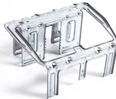
Denna nackstödskomponent till personbil är en komplex högvolumkomponent med snäva toleranser. För att kunna tillverka den krävs en effektiv produktionsprocess bestående av automatpressning, hydraulisk formning och robotceller för svetsning.
