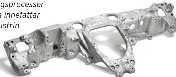
Instrumentpanelbalkar är exempel på strukturer som tillverkas i olika material såsom magnesium (som exemplet på bilden), stål eller multi-material beroende på kundens behov utifrån till exempel vikt och hållfasthet.
