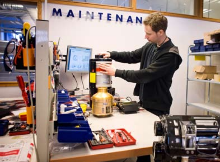
Zonal Dryer monteras efter reparation.
