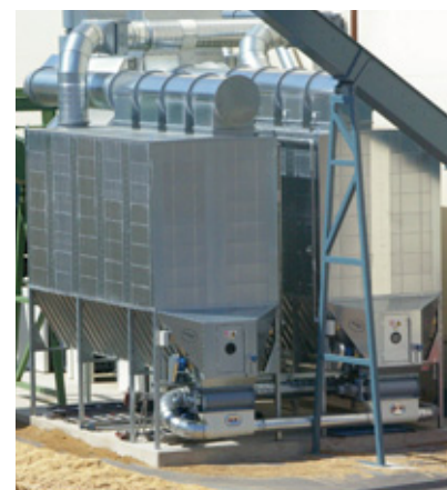
FS-filter passar för applikationer där stora volymer heta rökgaser ska filtreras.
