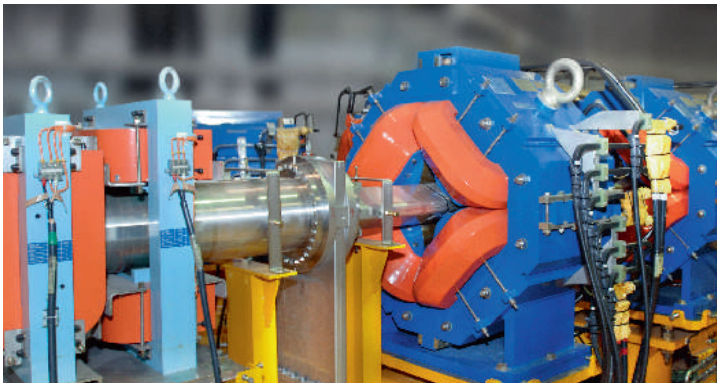
Accelerationen av partiklar vid proton- och koljonsbehandlingar kräver avancerad utrustning och mycket plats. Bestrålning med protoner eller koljoner gör det möjligt att styra strålningen genom att kontrollera partiklarnas hastighet. På bilden visas en av de magneter som fokuserar jonstrålen.
