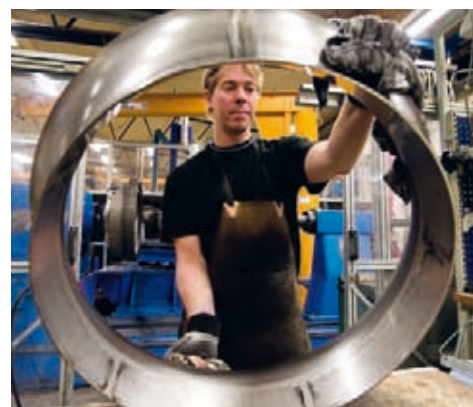
Trycksvarning av detalj till omrörsenhet.
