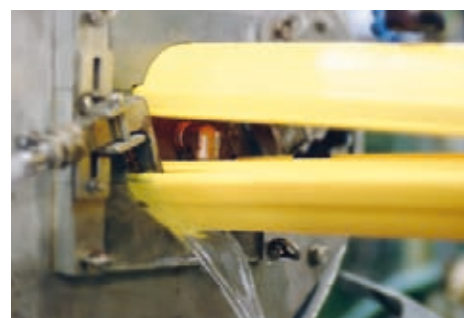
Extrudering av delbart rör, en av Profilspecialistens egna produkter.
