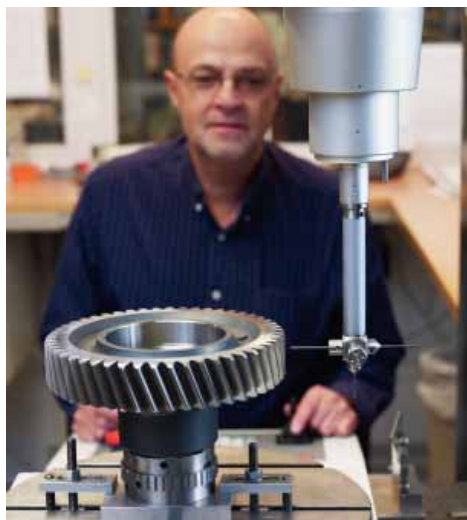
Verifiering av kuggdata på kugghjul hos Mikroverktyg. Här spelar en tusendels millimeter roll för att undvika att missljud uppstår i slutprodukten.
