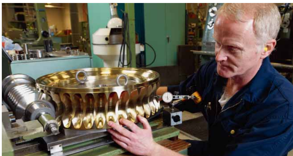
Exakt precision är avgörande för kundens slutresultat vid produktionen av snäckväxlar hos Mikroverktyg.
