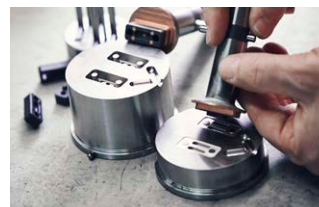
Insatsverktyg lämpat för små plastdetaljer i mindre produktionsserier.
