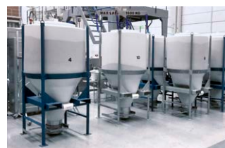
Doseringssilo i livsmedelsgodkända och återvinningsbara material.
