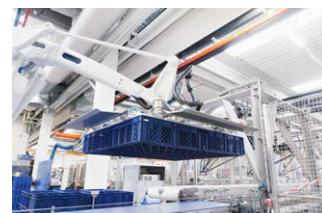
Robotiserad hanteringsutrustning för påsförpackningar.
