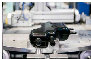
Bearbetningscell för styrservo-behållare i polyamid.
