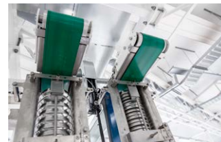
Transportörsystem för livsmedelsförpackningar i metall.
