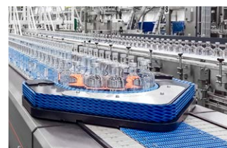
Buffertlösning för glasflaskor som reglerar flöden i produktionslinjer.
