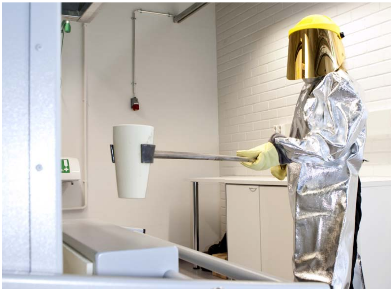
Laboratoriet i Pampalo, smältning av guldkoncentrat för haltbestämning
