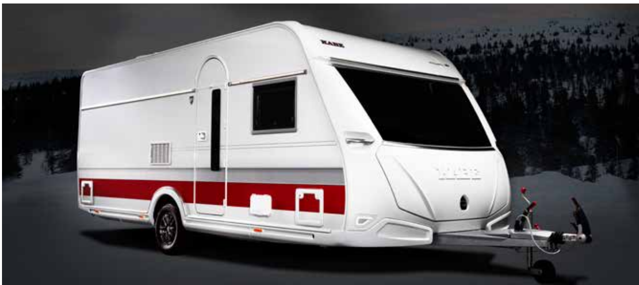
KABEs nya aerodynamiska kaross med den nya bakvingen är utvecklad för att minska luftmotståndet.
