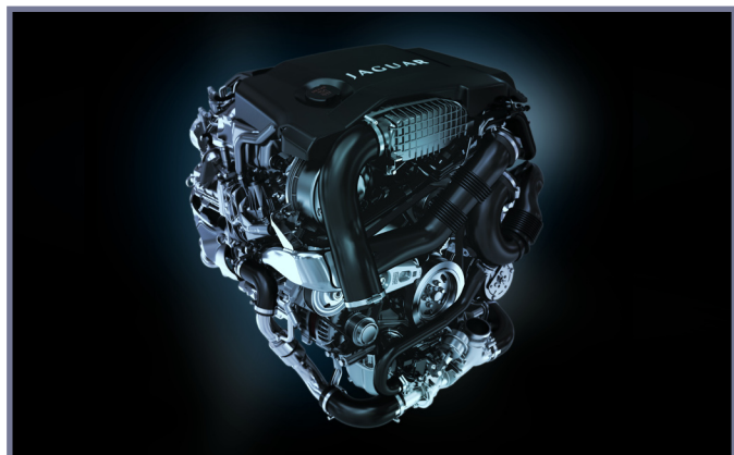
Den nya Jaguar 3.0 liters V6 turbodieselmotorn, baserat på ett SinterCast-CGI motoblock, ger en 12 %-ig förbrukningsminskning och en 10 %-ig CO 2 -utsläppsminskning jämfört med V6-föregångaren på 2.7 liter. (Med tillstånd av Jaguar)
