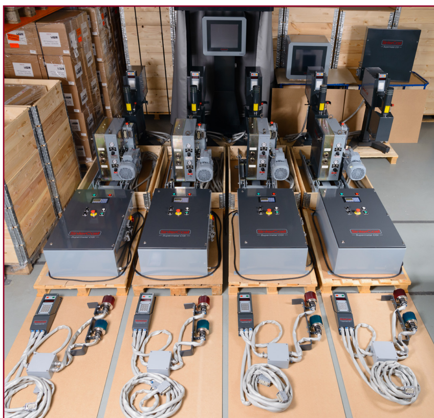
SinterCasts första installation någonsin av System 3000 Plus annonserades 29 oktober 2012. Konfigurerad med fyra trådmatare och fem provtagningsmoduler kommer System 3000 Plus att tas i drift hos Tupy Saltillo-gjuteriet i Mexiko under mars-april 2013 och det är byggt för att kunna stödja produktion av 15 skänkar i timmen under fler än 9 timmars serieproduktion per dag.
