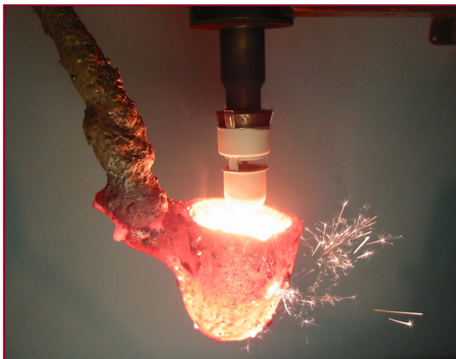
SinterCasts unika provtagning genom nedsänkning
