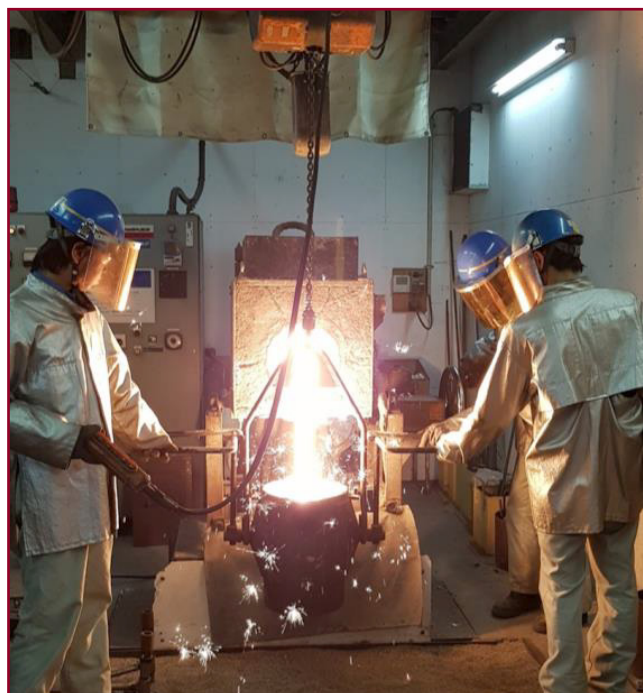
Ett Mini-System 3000 installerat i Kimura-gjuteriet i Japan för CGI-produktutveckling, kompletterar Kimuras prototyp och nichvolymproduktion med 3D-printad sand och med SinterCasts processtyrningskunnande inom CGI.
