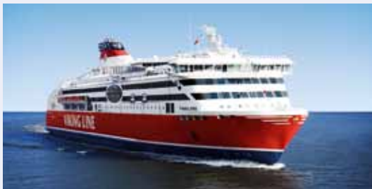
VIKING XPRS Rakennettu 2008 • BRT 35 918 • Pituus 185,0 m Jäätaluokka I A Super • 2 500 matkustajaa • 220 henkilöautoa 728 vuodepaikkaa • Helsinki–Tallinna • Ruotsin lippu
