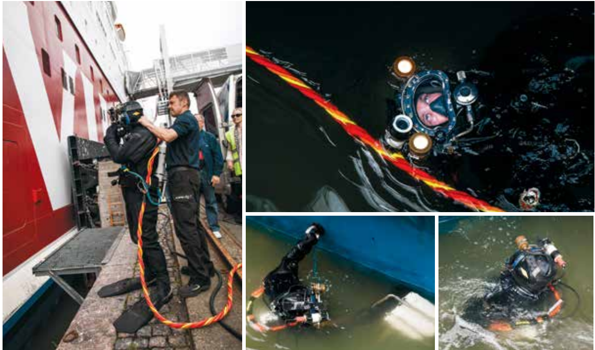
Sukeltajat harjaavat alusten pohjaosat monta kertaa vuodessa. Kaikki kasvillisuus, joka irtoaa pohjaosista harjauksen yhteydessä, kerätään erilliseen säiliöön, joka sitten viedään maihin edelleen käsiteltäväksi.
