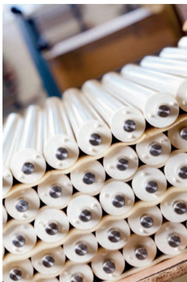
Valser i hård PUR til filmfremkaldere (X-Ray)
