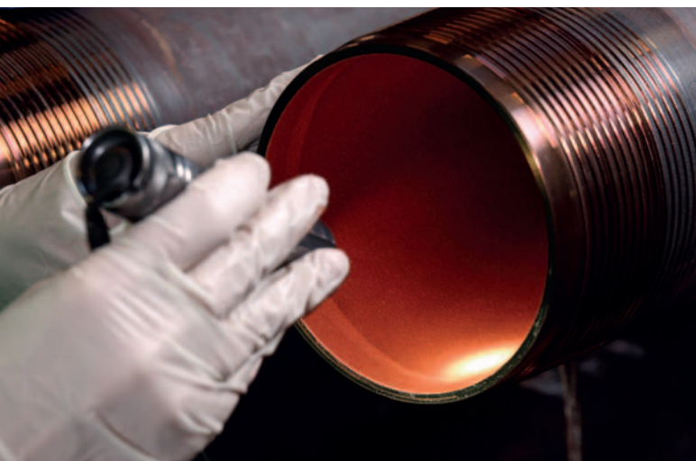
Accoats kvalitetskontrol af overfladebehandlede rør med DuPont™ StreaMax™ til olie og gas industrien
