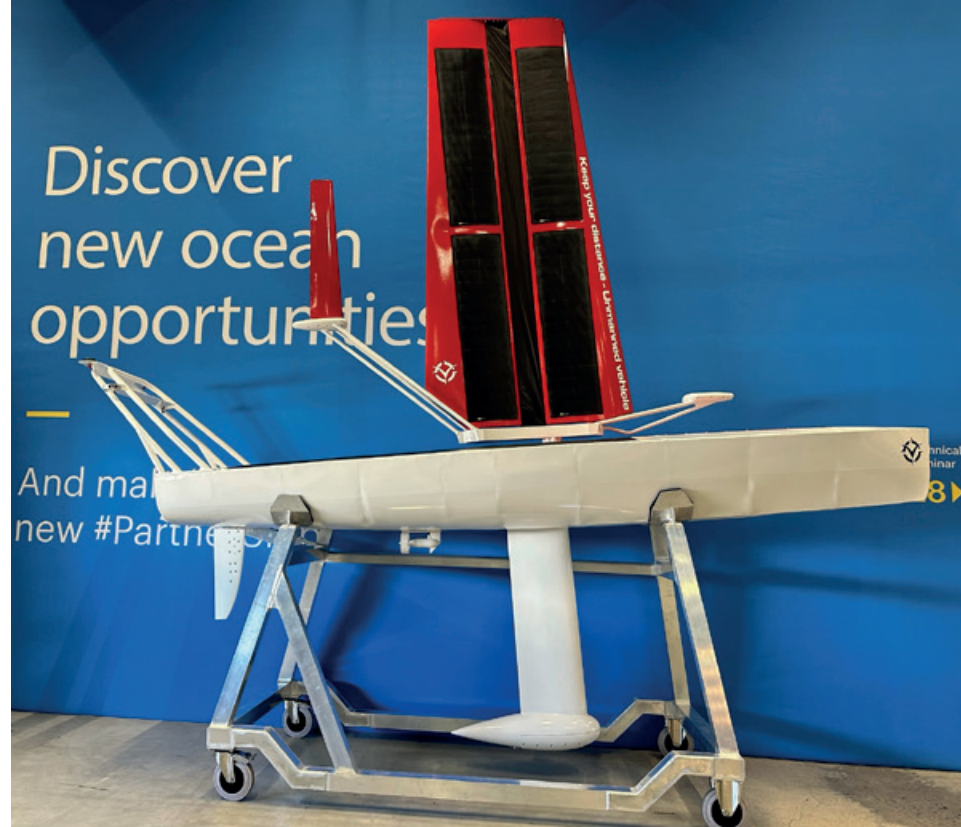
Den fire meter lange slanke og elegante seildronen er fylt med avansert teknologi, for å kunne utføre krevende datainnsamling langt til havs. Foto: Linda Bay, Kjeller Innovasjon
