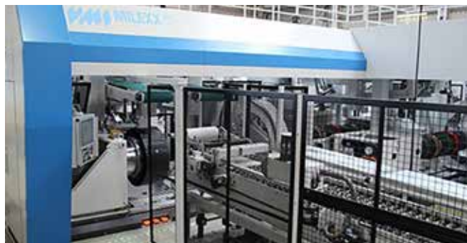
MILEXX is de nieuwe generatie truckbandenbouwsystemen en is ontwikkeld conform de MAXX®-technologieprincipes van VMI. Het beschikt over een aantal unieke technische innovaties en behaalt een capaciteit van bijna 700 banden per dag.
