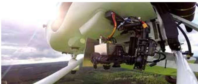
'Aerial'-beeldvorming kan worden gebruikt voor milieu-, landbouw- en bosbouwonderzoek, bijvoorbeeld door een combinatie van conventionele en warmtebeeldcamera's.
