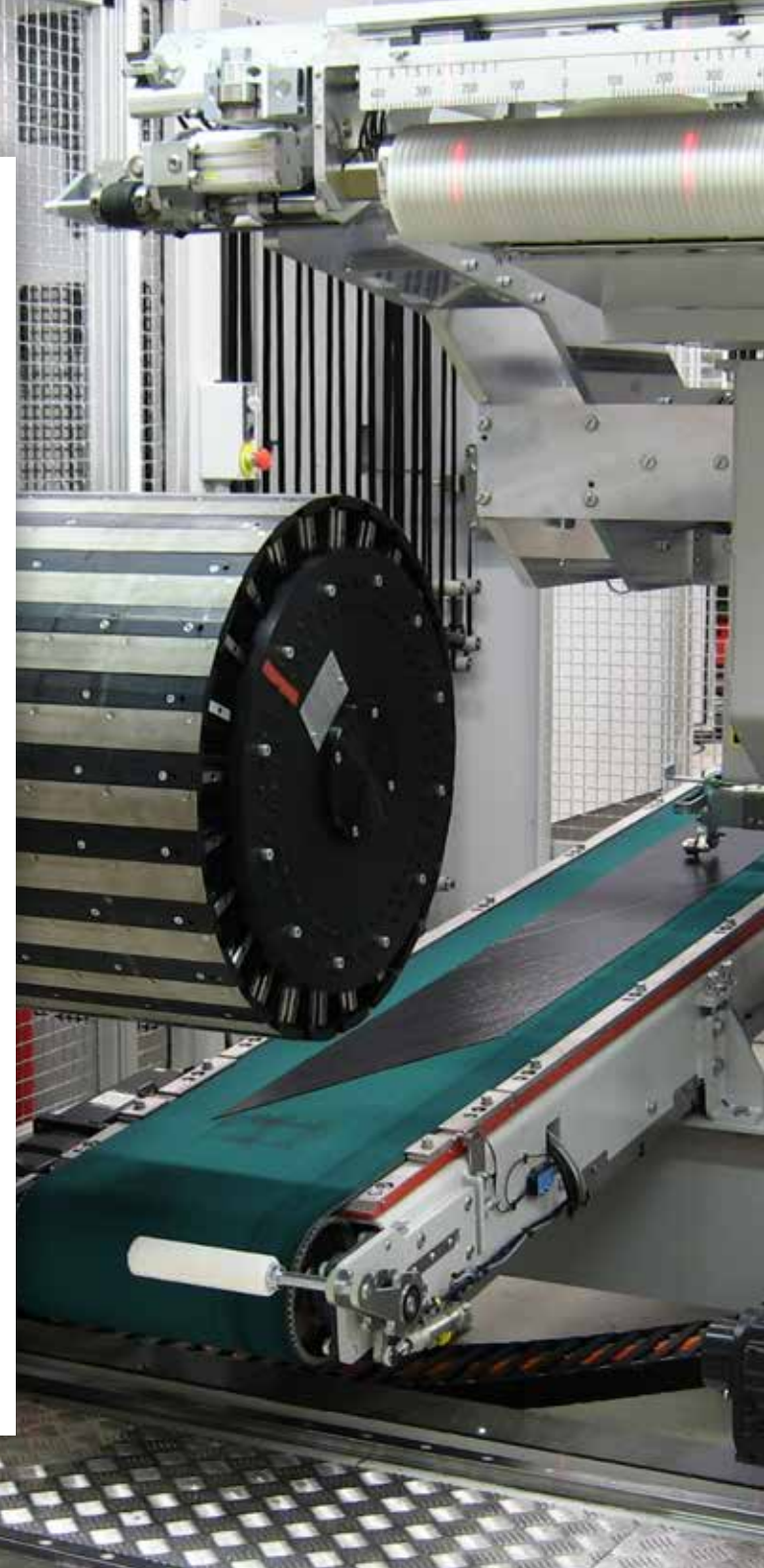
MILEXX is de nieuwe generatie truckbandenbouwsystemen en is ontwikkeld conform de MAXX®-technologieprincipes van VMI. Het beschikt over een aantal unieke technische innovaties en behaalt een capaciteit van bijna 700 banden per dag.
