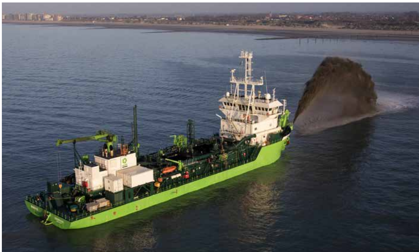
DEME - Le Minerva est la première drague au monde pouvant fonctionner au GNL
