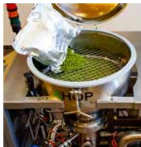
Agidens - Ahop drooghopeninstallatie
