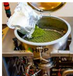
Agidens - Installation de séchage du houblon Ahop
