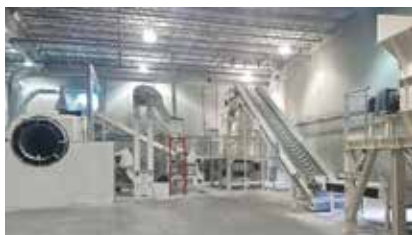
Séparateur de verre utilisé par le partenaire de Safelite, Shark Solutions, pour recycler les pare-brise.
