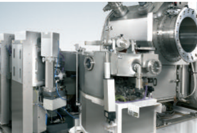
Neue TIMARIS Beschichtungsanlage für MRAM Wafer in der Montage
