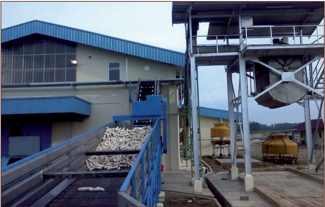
En Indonésie, la nouvelle usine d'Enzybel International est installée dans une plantation d'ananas. Les racines des plans d'ananas sont collectées et traitées pour en extraire et purifier de la bromélaïne, une enzyme active végétale recherchée.
