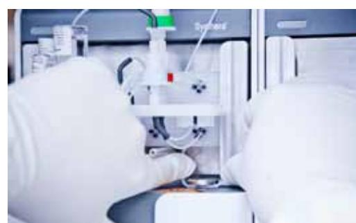
*Synthera® est un module de synthèse complet destiné à la production de molécules TEP.*
