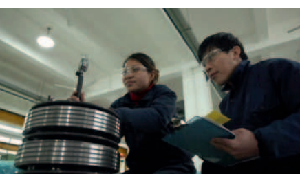
Fabrication de baguiers de puissance dans une filiale Mersen en Chine
