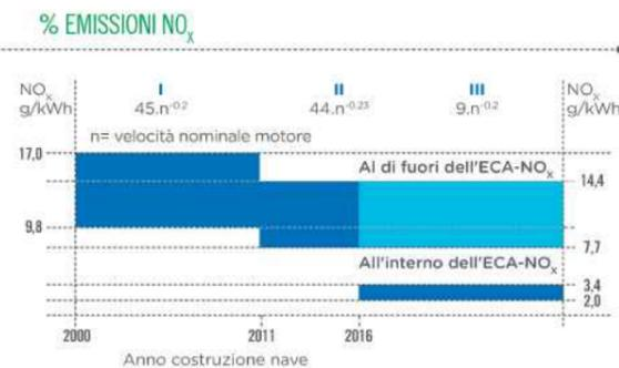
La configurazione attualmente più utilizzata per la riduzione delle emissioni si basa su **motori diesel di ultima generazione** abbinata all'installazione di sistemi di depurazione dei fumi nei sistemi di scarico.
