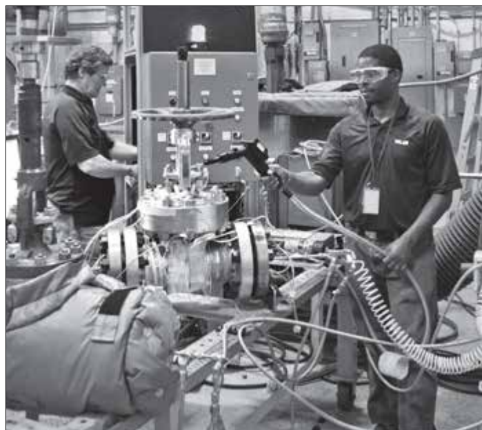
Essais d'émissions fugaces sur un robinet-vanne en acier moulé de 4 po (100 mm) classe 600.
