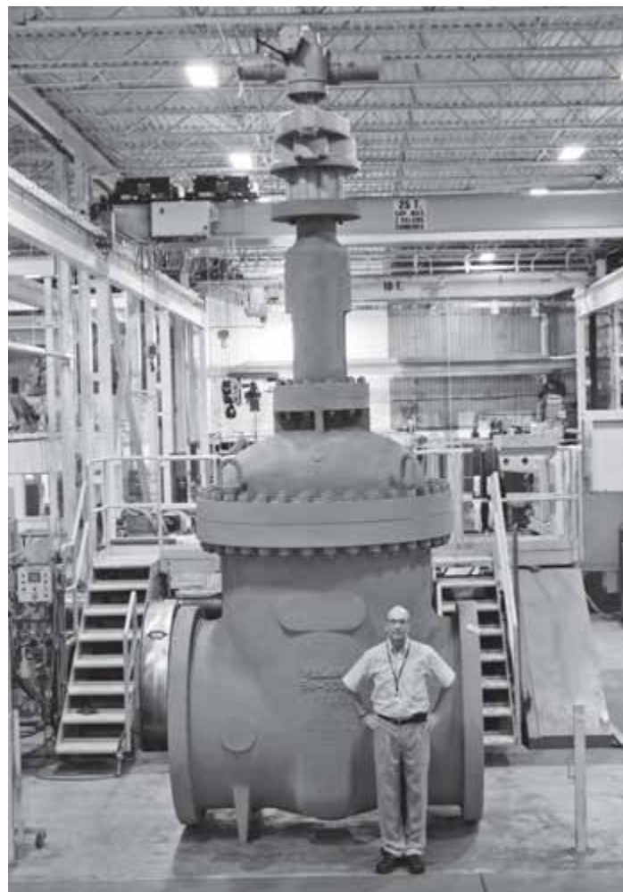
Ce robinet-vanne en acier moulé de 54 po (1 350 mm), de classe 300, est destiné à une usine de polyéthylène qui doit ouvrir en 2015. C'est l'un des plus gros robinets produits par Velan à ce jour, avec une hauteur de plus de 34 pi (10,36 m) et une largeur de 7 pi 6 po (2,29 m). Son poids est de 48 000 lb (21 772 kg) incluant l'actionneur. Debout devant le robinet, Stephen Cherlet, Chef des opérations de Velan.
