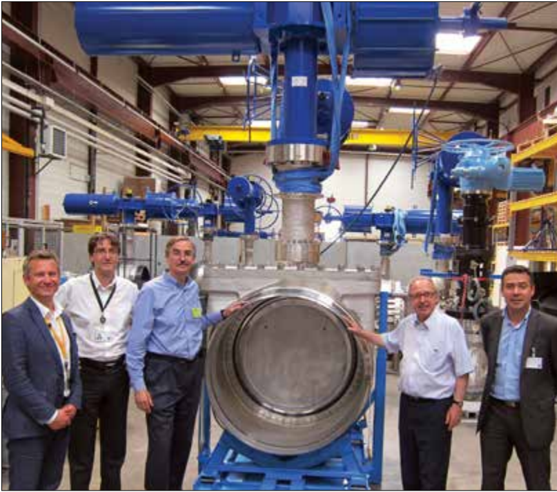
Des membres de l'équipe dirigeante de Velan France avec Tom Velan à l'usine de fabrication Velan S.A.S., à Lyon, France, entourant un gros robinet papillon cryogénique à entrée par le haut, 36 po (900 mm), prêt à être livré à une installation de GNL.
