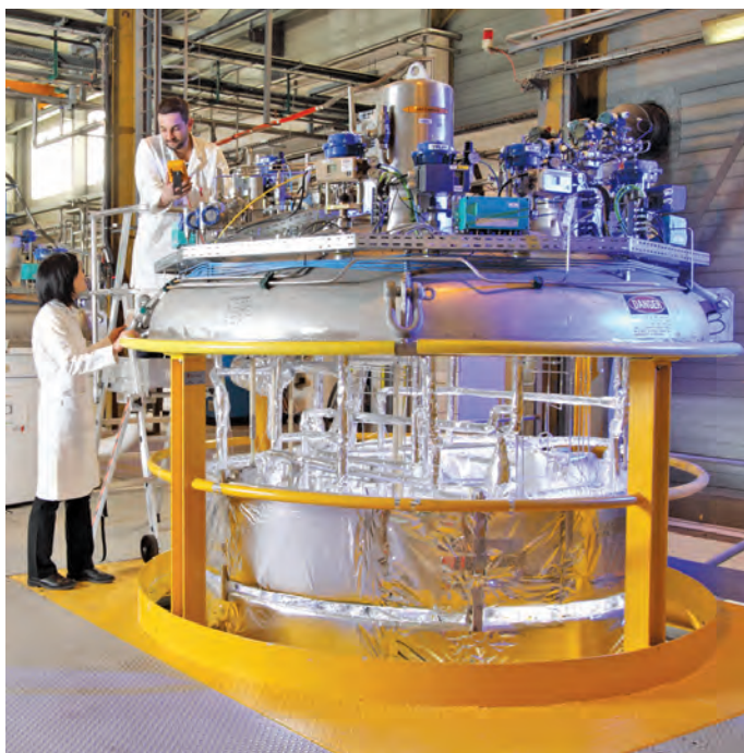
Velan SAS a fabriqué ces robinets cryogéniques de régulation à soufflet pour l'application d'hélium liquide dans un réacteur de fusion nucléaire au Japon. Crédit photo: P.AvavianCEA.
