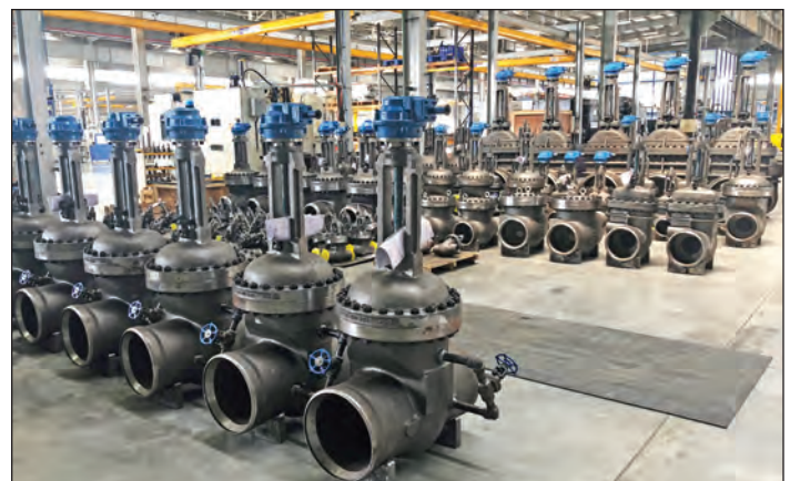
Robinetts-vannes en acier moulé fabriqués pour la centrale supercritique NTPC Telangana et prêts à être expédiés de notre usine en Inde.
