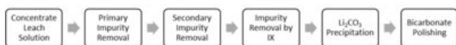
Figure 2. Schéma de la production de carbonate de lithium (Groupe CNW/Vision Lithium Inc.)
