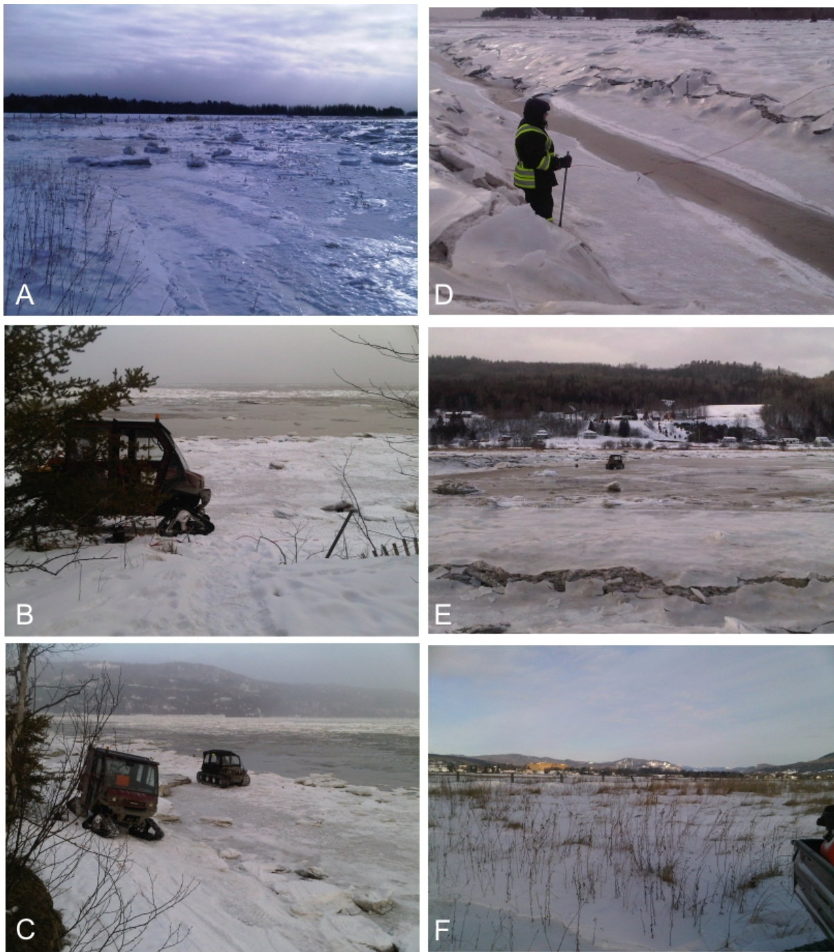
Figure 11. Photographies de terrain prises lors du levé ABEM LS de l'hiver 2011. A : bordure de l'estran. B et C : chenillettes utilisées le long de la plage de Baie St-Paul, ligne L1. D : installation des câbles électriques. E : zone supralittorale inondée par les grandes marées. F : secteur situé au sud du chemin de fer, ligne L2 (Les Mines J.A.G. Itée).
