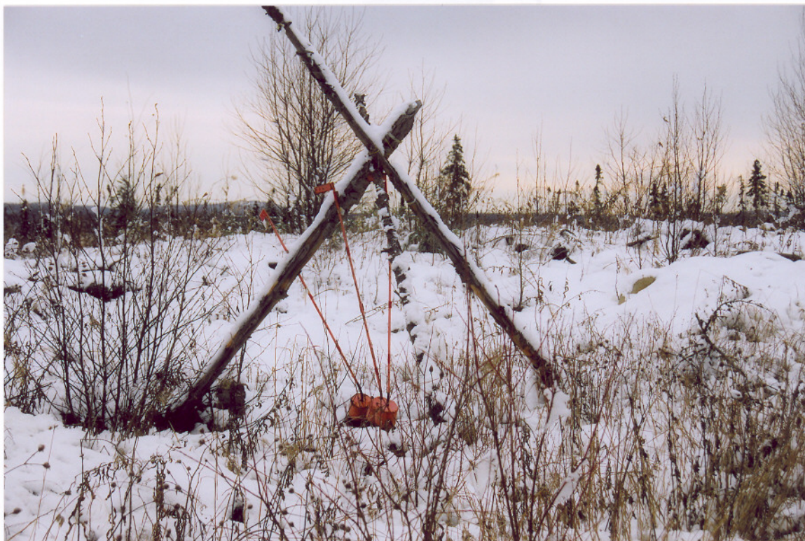
Vue de collets de forages, situés sur le gîte Caber
