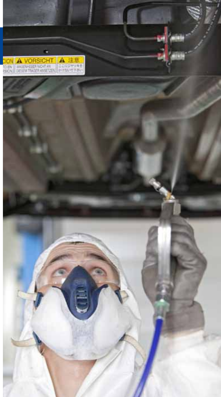
Pkw-Hohlraumversiegelung bei BLG AutoTec in Bremerhaven
